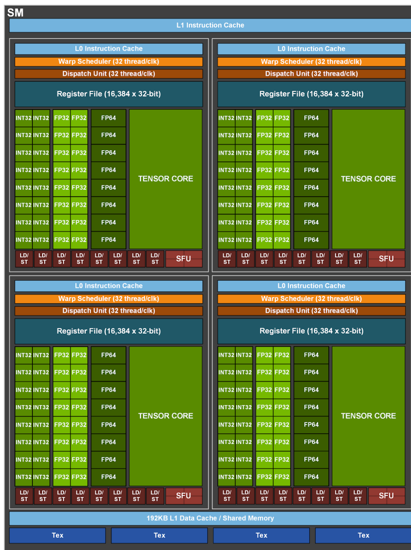
Рис. 5.5.2. Структура потокового мультипроцессора NVIDIA Ampere GA100 (источник изображения – [53])
