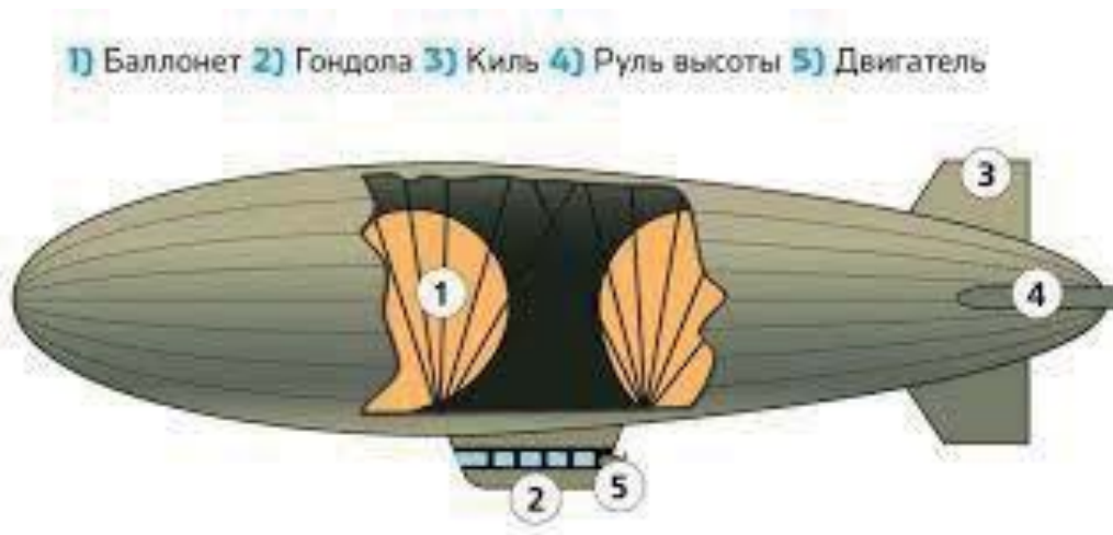
Рис. 2.11. Элементы управления в дирижабле
