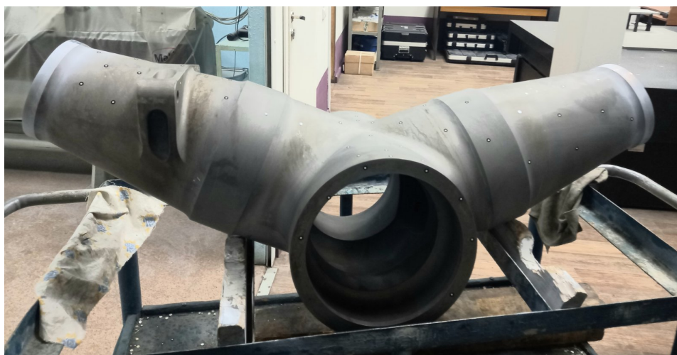
Рис. 6.1. Траверса на участке контроля пространственных отклонений от действия остаточных напряжений
