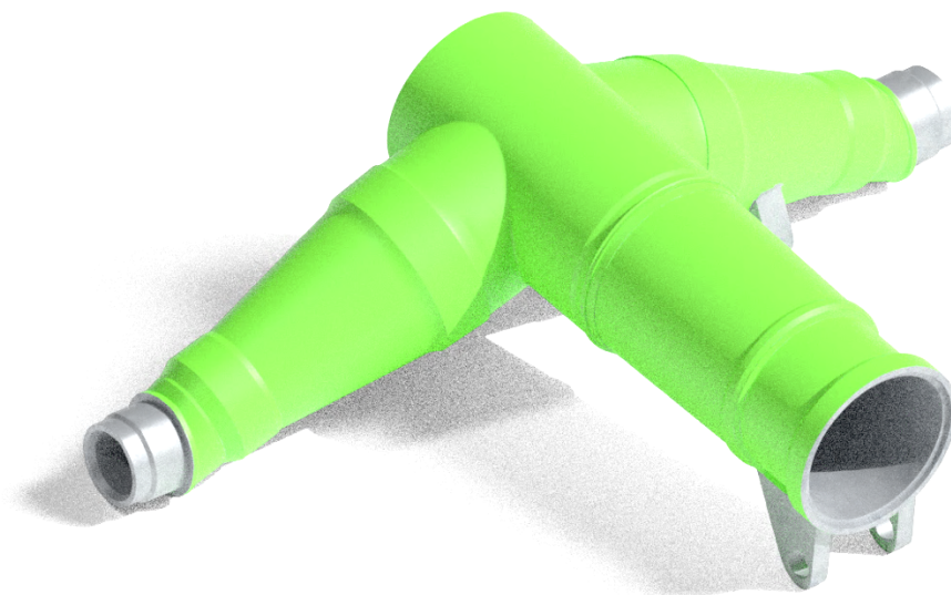
Рис. 1.3. Обрабатываемые поверхности детали «Траверса»
