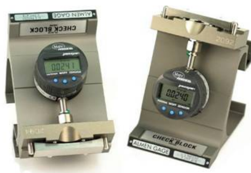
Рис. 4.1. Современные приборы TSP-3 для измерения деформации образца-свидетеля согласно стандарту SAE J442
