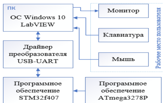
Рис. 3.11. Структурная схема взаимодействия программного обеспечения АПК.
