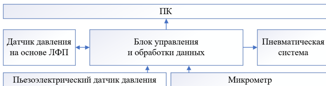
Рис. 3.1. Структурная схема аппаратно-программного комплекса.
