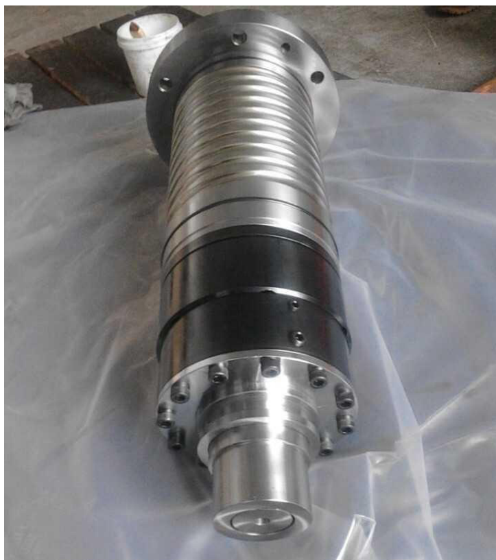
Рис. 5.11. Пример выполнения канавок на наружной поверхности гильзы
