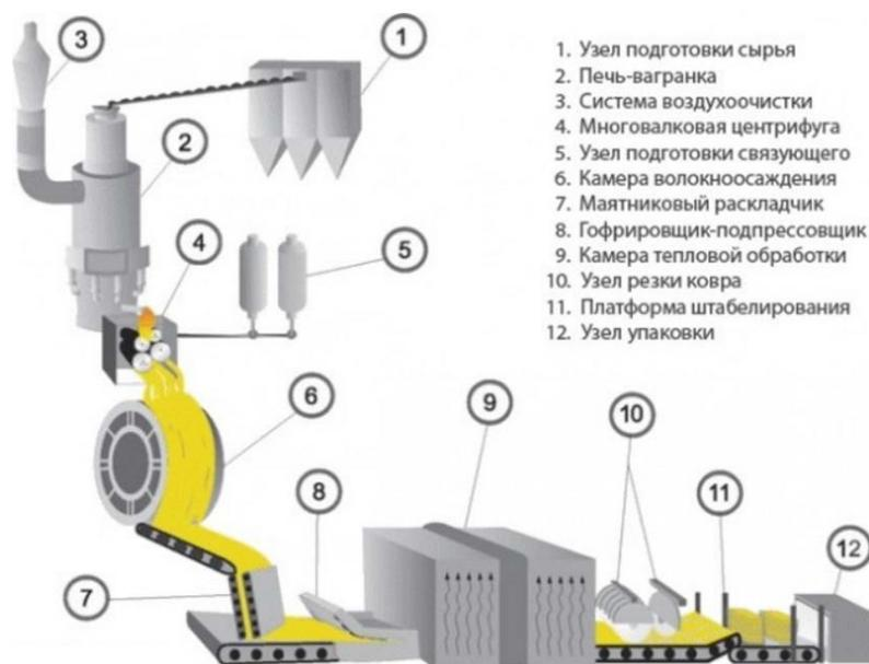
Рисунок 4.19 – Технология производства минеральной ваты
