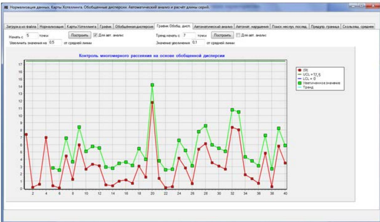
Рисунок 3.7 – График обобщенной дисперсии при скачкообразном увеличении рассеяния
