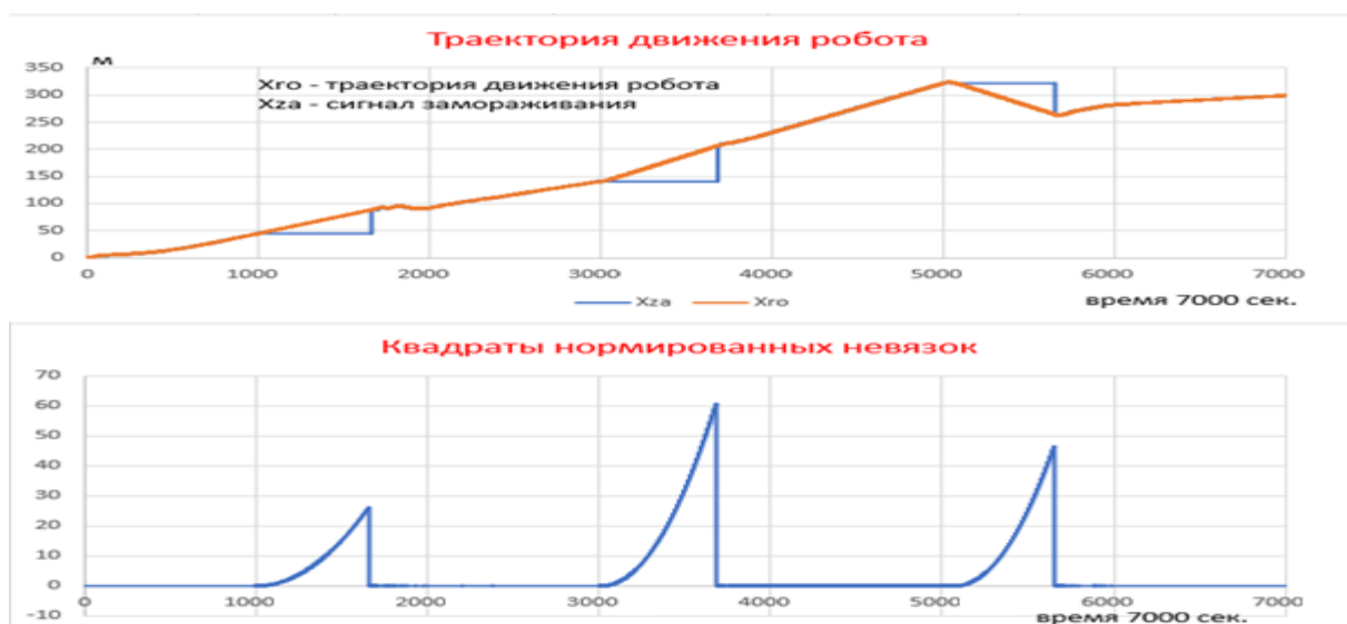
Рисунок 3.18. - Результат моделирования обнаружения отказов вида "замораживание" сигнала на выходе приемника СНС на основе невязок ФК [130]
