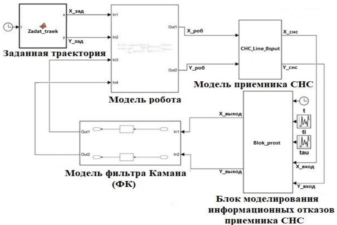
Рисунок 3.17. - Схема моделирования системы управления мобильным роботом с контролем информационных отказов приемника СНС на основе невязок фильтра Калмана [128]
