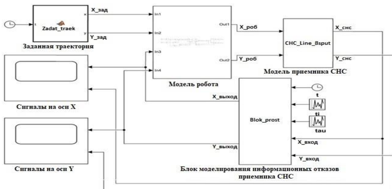
Рисунок 3.2. - Схема моделирования системы управления наземного робота с приёмником СНС, работающим с отказами
