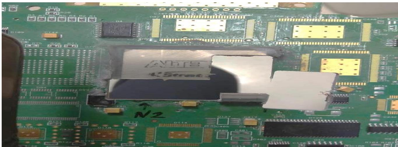
Рисунок 3.6 -Микросхема D1 (EP2S60F1020I4N ALTERA) модуля МФЭ
