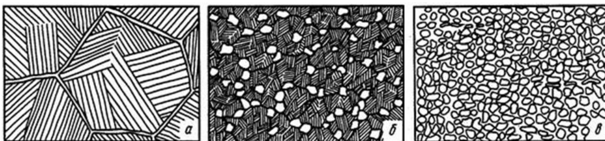
Рис. 2.5. Типичные микроструктуры двухфазных титановых сплавов после отжига. а – пластинчатая, б – смешанная (дуплексная), в – равноосная (глобулярная). [60]
