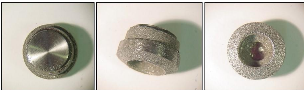
Рис. 3.28. Мембрана ТП, изготовленная по SLM технологии из порошка Ti-6Al-4V.
