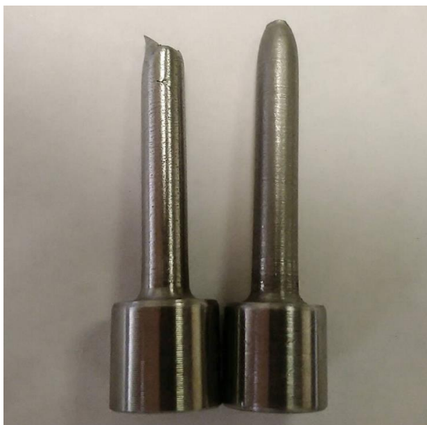
Рис. 2.17. Образец из сплава ВТ6 с упрочняющей термообработкой (слева, фиолетовая кривая на рис. 2.16) и без нее (справа, синяя кривая из рис. 2.16).
