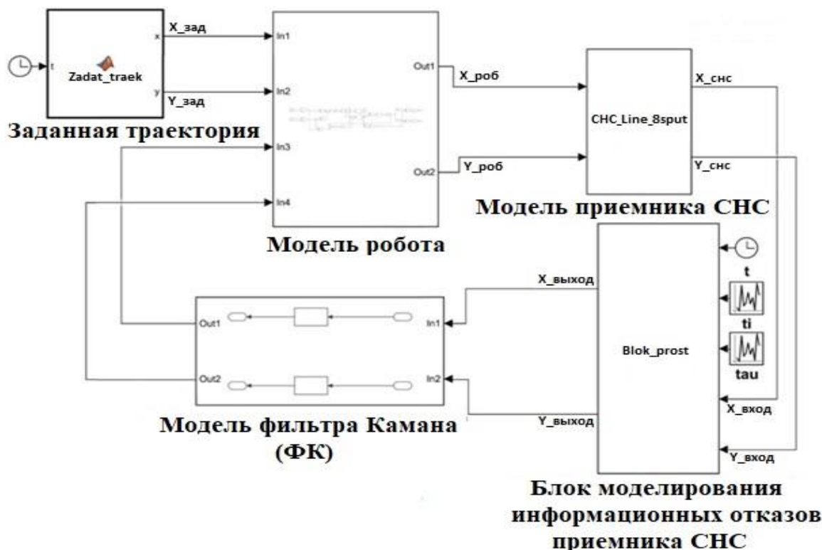
Рисунок 3.17. - Схема моделирования системы управления мобильным роботом с контролем инфомационных отказов приемника СНС на основе невязок фильтра Калмана [128]
