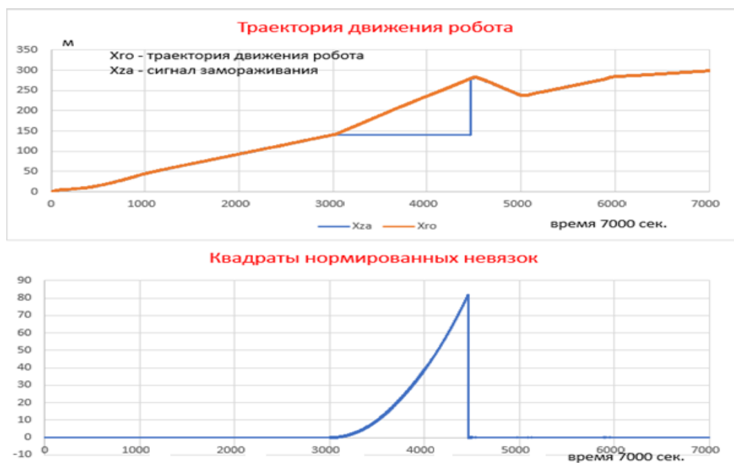
Рисунок 3.19. - Результат моделирования обнаружения информационного отказа приемника СНС на основе невязок ФК
