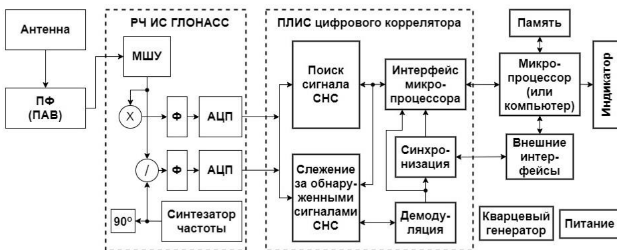
Рисунок 1.2. - Обобщенная структурная схема приемника СНС (на примере ГЛОНАСС)
