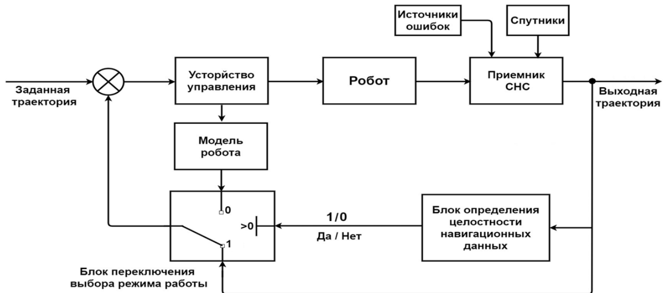
Рисунок 4.1. - Структурная схема системы управления мобильным роботом с выбором режима управления
