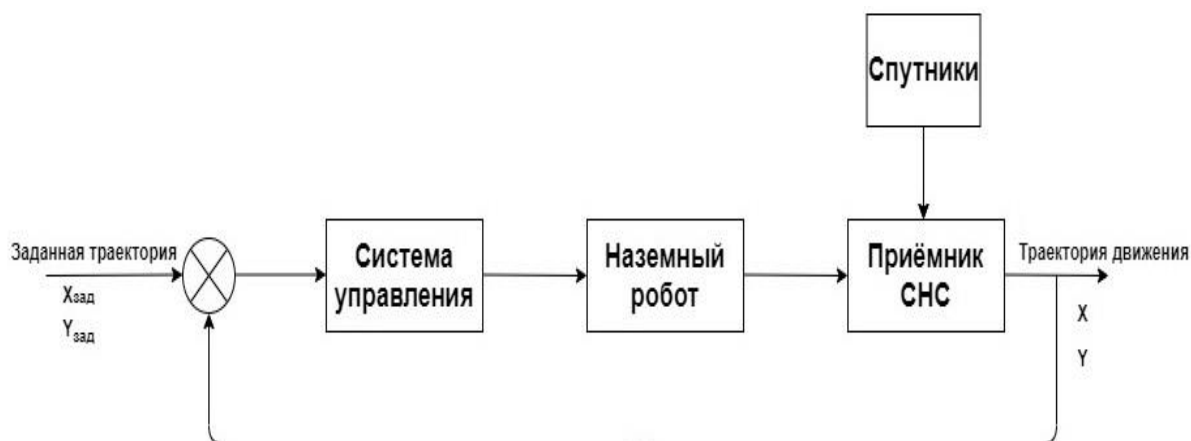
Рисунок 1.1. - Схема управления наземным роботом с СНС
