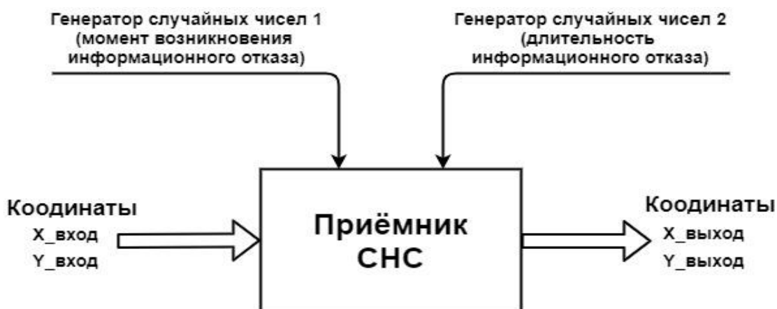
Рисунок 3.1. - Схема моделирования информационных отказов приемника СНС
